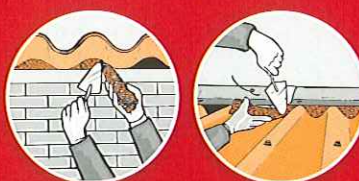
Tætning af bølgeplader
